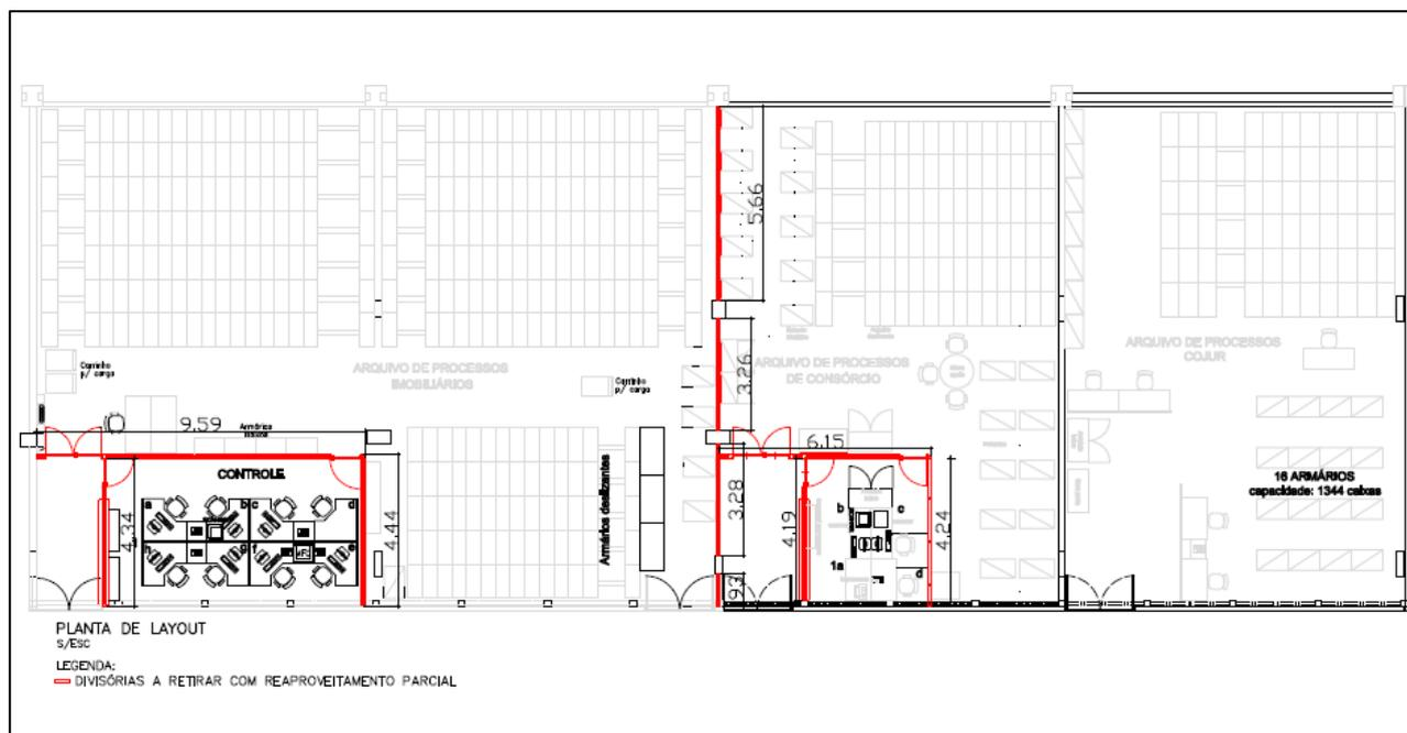
Figura 1 – Planta baixa com indicação de divisórias e portas a serem retiradas.
